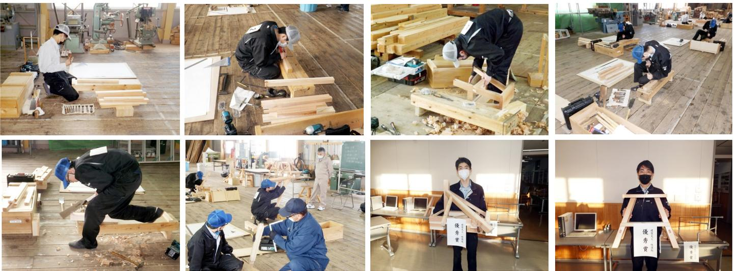
参加した訓練生は図面を見ながら木材にカンナを掛けたり墨付けを行ったり、ノミやノコを使って切削加工に挑み、制限時間内に完成させて提出できるよう、時計を見ながら作業をしていました。審査は同校の元指導員である坂本昭義氏が審査員となり、出来上がった作品のひとつひとつを確認しながら寸法の正確さや仕上げの美しさなどを採点しました。
