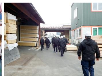
機械の性能が向上し、現在では様々な継手・仕口の加工が可能になったということです。柱や梁等を機械で加工するので、継手・仕口が円弧状になっているのがプレカットの特徴です。工場内のストックヤードでは柱や梁など各部位ごとに材を保管しており、加工した材は物件ごとにまとめてビニールで養生し出荷されます。
