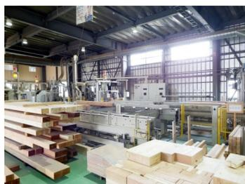
当初は軸組材だけが機械プレカットの対象でしたが、現在では加工範囲が大きく拡大し、羽柄材（根太、間柱、筋交、垂木等）もプレカットできる工場が増えています。また、床合板や野地板などのパネルを加工する機械も普及してきており、床合板や野地板にも割付図が作成され、各部分材に番号がふられて現場に納品されるようになったことで、現場加工の手間が減り、軸組材のみのプレカットが行われていた頃と比べて現場作業の効率が向上しています。
