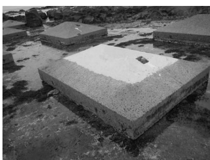
写真-6 被覆試験
