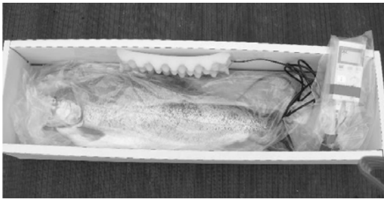
写真-5 段ボール梱包箱の保冷実験の様子
