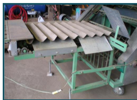
カッターを取り外した選別機
