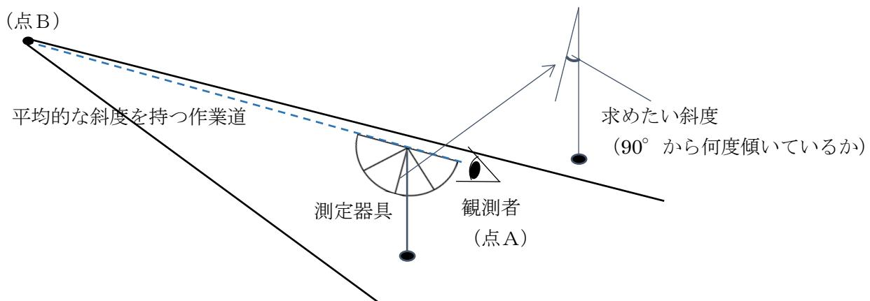
(計算式) 水平距離（取組延長）＝延長斜距離（実測）×補正係数
