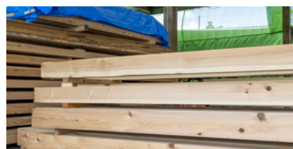
1.無垢材/原木から角材や板を直接必要な寸法に切り出した建材 2.数寄屋造り/茶室(=数寄屋)を建てる際の様式を取り入れた、日本の伝統的な建築手法
