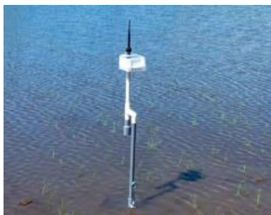
水田水位センサーによる計測
