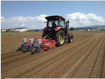
自動直進機能搭載農機による「直進は種」(左)、「中耕培土」(中)、「吊下げノズルでの除草剤の畦間・株間散布」(右)
