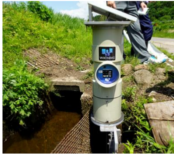
自動給水栓の実証試験
