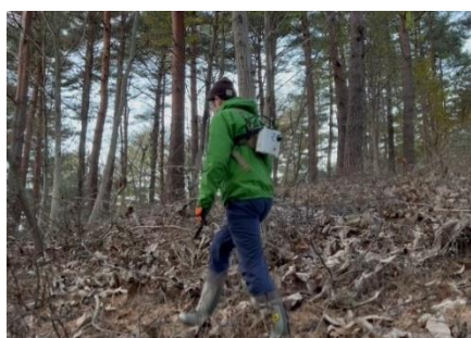
バックパック式地上レーザ計測
