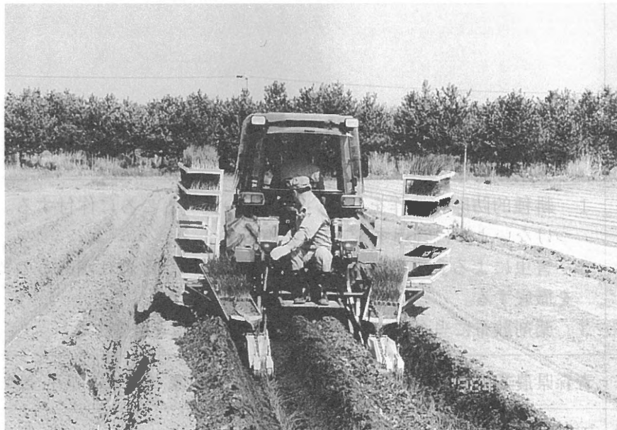
ねぎ移植機 (クボタ、TNP-200) による作業
