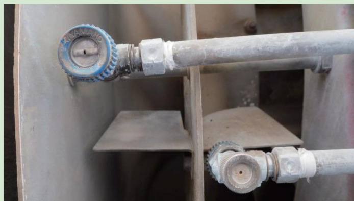
ドリフト低減ノズル（左）では慣行ノズル（右）に比べ、薬液の粒が大きく飛散しにくい
