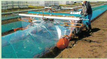
支柱打込機によるトンネル張り
