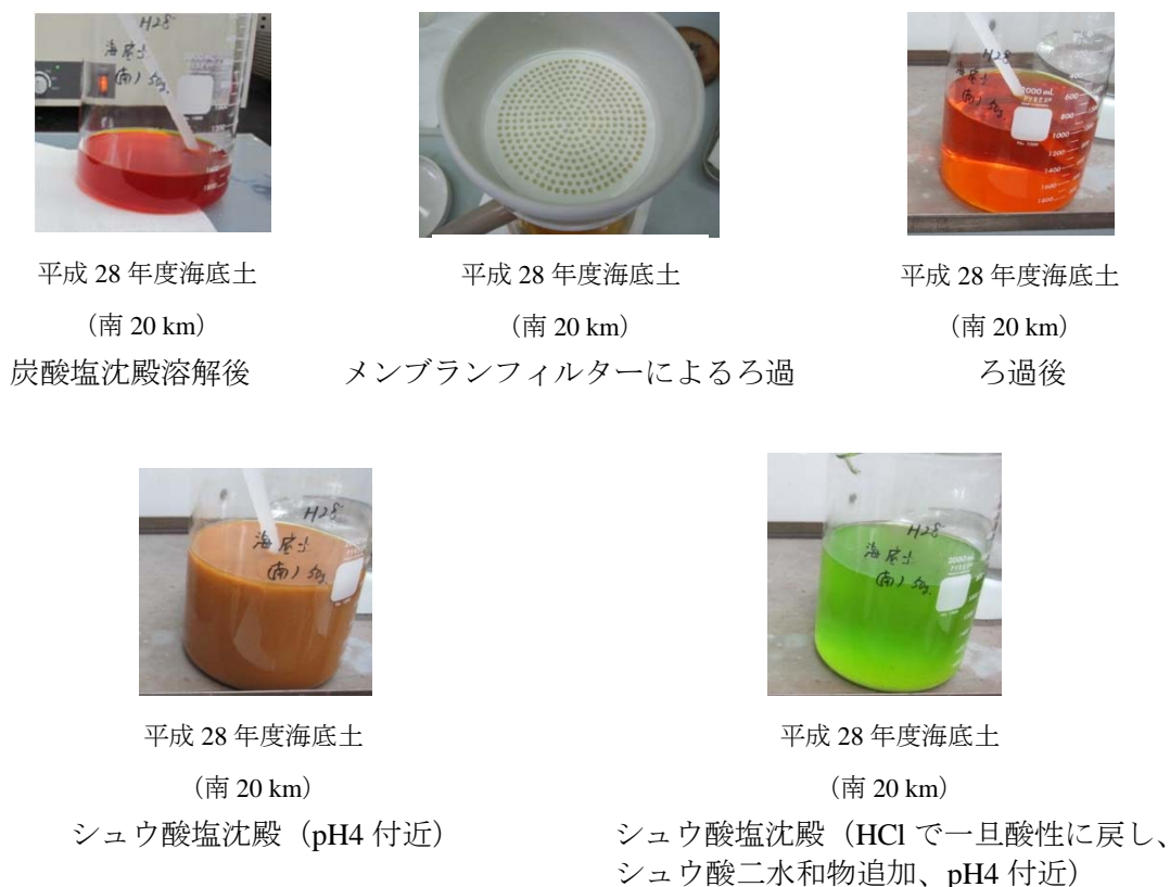
図7 不溶性ケイ酸のろ過及びシュウ酸二水和物の追加による再分析の状況
