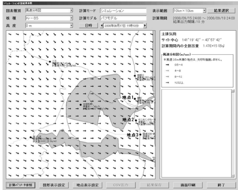
図13 再処理工場周辺地域における第1層（地上0m～地上約25m）の風速場（平成20年9月17日11:10）
