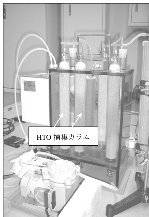
図 3 化学系別トリチウム採取装置
