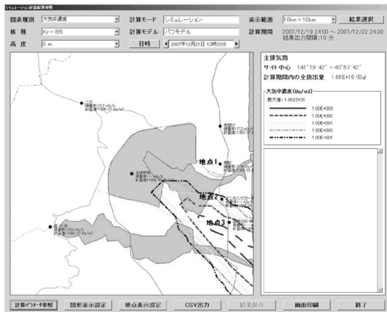
図8 シミュレーションシステムによる大気中Kr-85の拡散・分布状況 (平成19年12月21日12:20)
