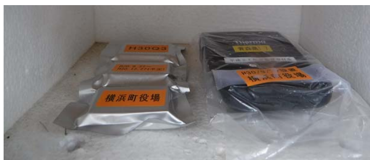
図 2 EPD 及び RPLD の積算線量収納箱への収納状況
