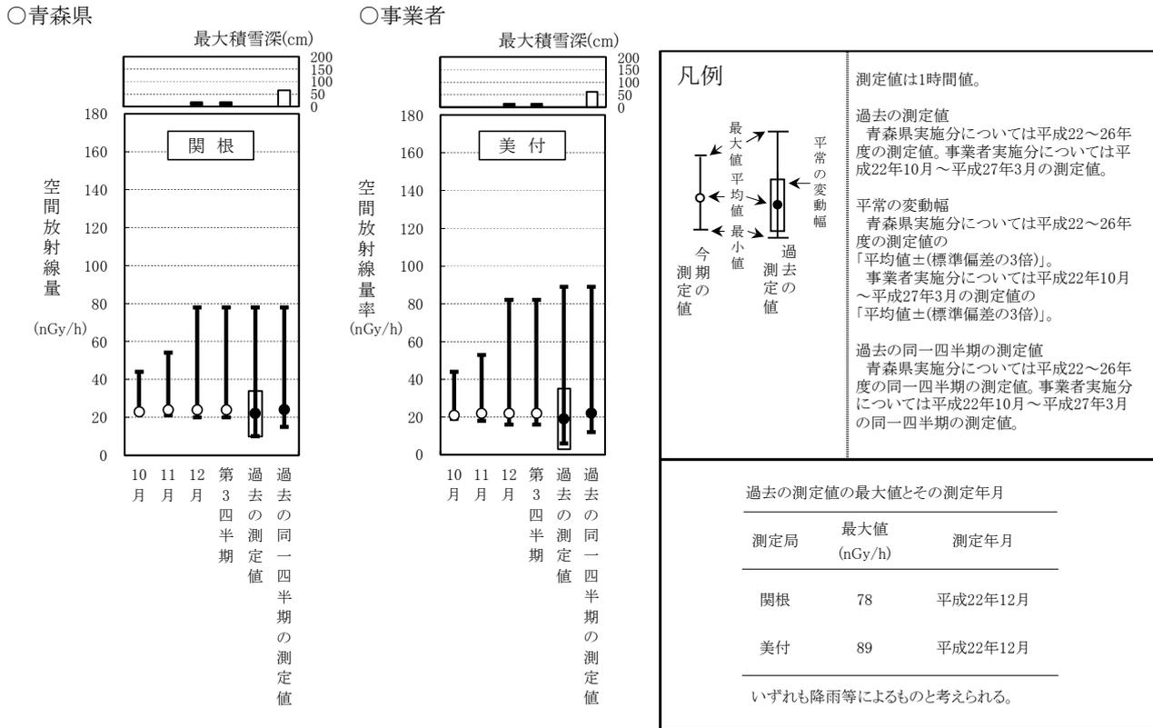
図 2-2 RPLD による積算線量測定結果<sup>(注1)</sup>
