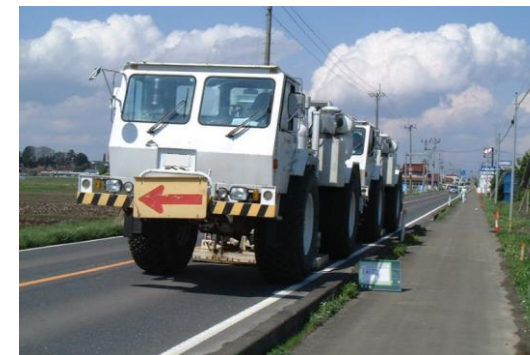
海陸連続探査で使用する起震車(イメージ)
