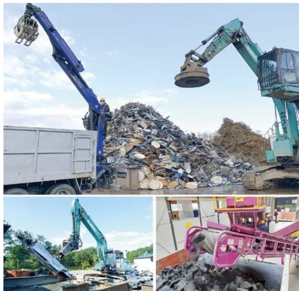
金属、廃車、廃タイヤの処理設備
