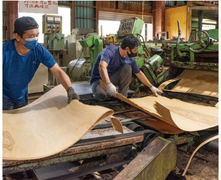
原木をかつら剥きできる国内で希少な技術。この過程で出る廃材がe・wood+の材料になる
