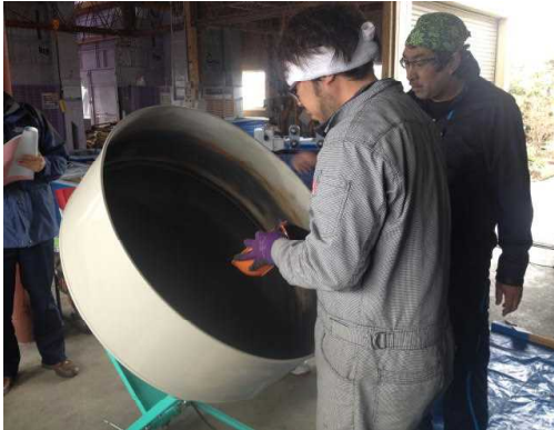
鉄粉+焼石膏のコーティング作業
