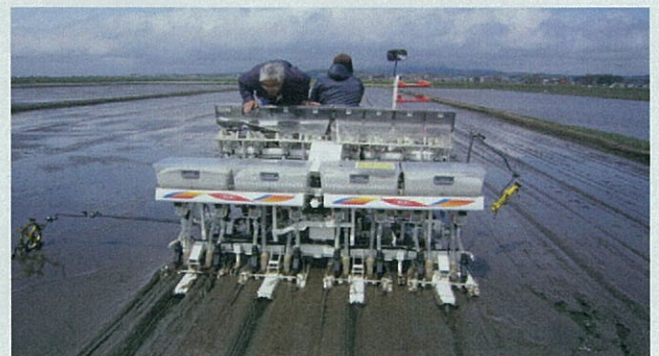
青森市浪岡地区では、湛水直播機のフロートに作溝装置を装着し、排水性を高めて出芽の安定に取り組んでいます
