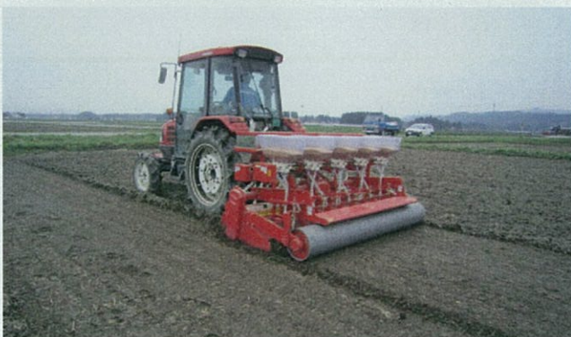
青森市油川地区では、スリップローラーシーダーを導入し、乾田直播栽培に本格的に取り組む農家も出てきています
