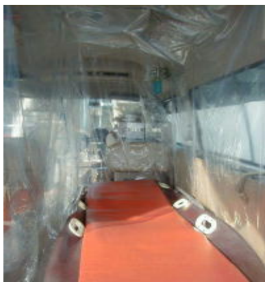
患者収容部分を分画した例(内部)
