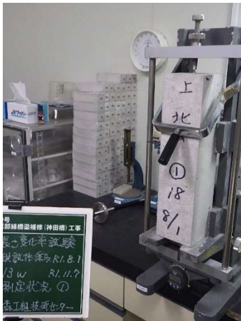
6ヶ月間の長さ変化試験 (青森県生コンクリート工業組合技術研修センター)
