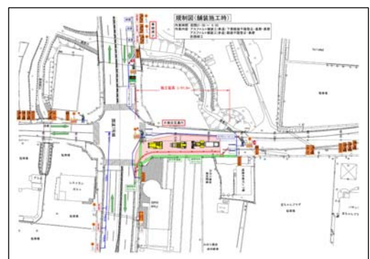
規制図(舗装施工時)
