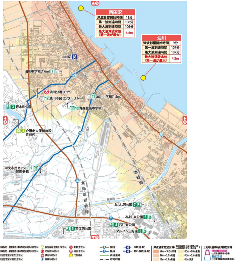
図 日本海溝モデルによる津波浸水想定区域 (西田沢・油川地区)
