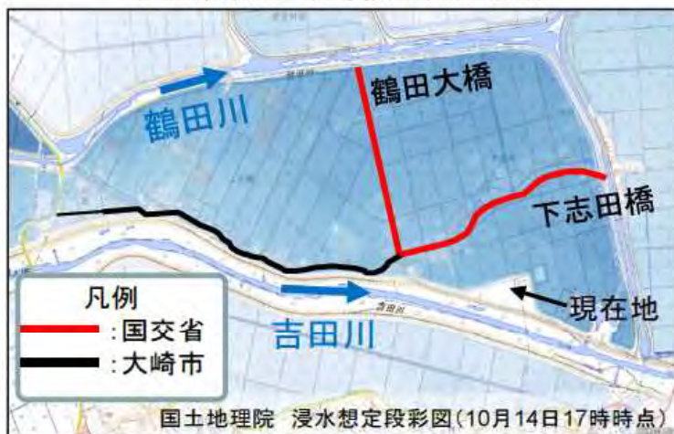
道路啓開 土砂等撤去実施箇所
