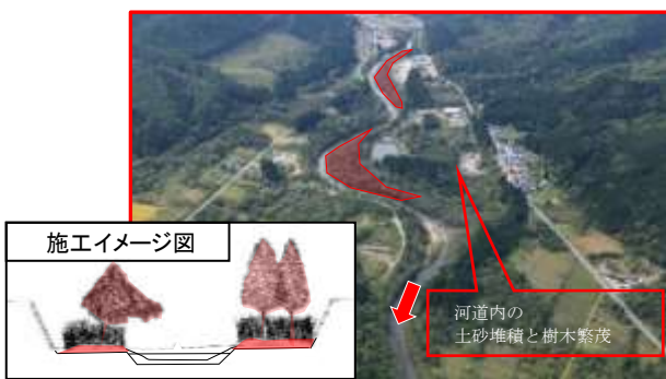
樹木伐採・河床掘削イメージ
