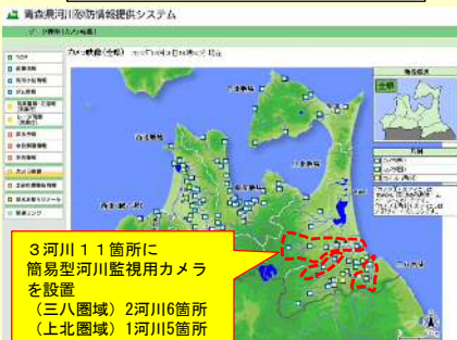
簡易型河川監視用カメラ設置箇所
