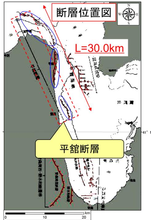
図-6 地震津波の波源域を設定
