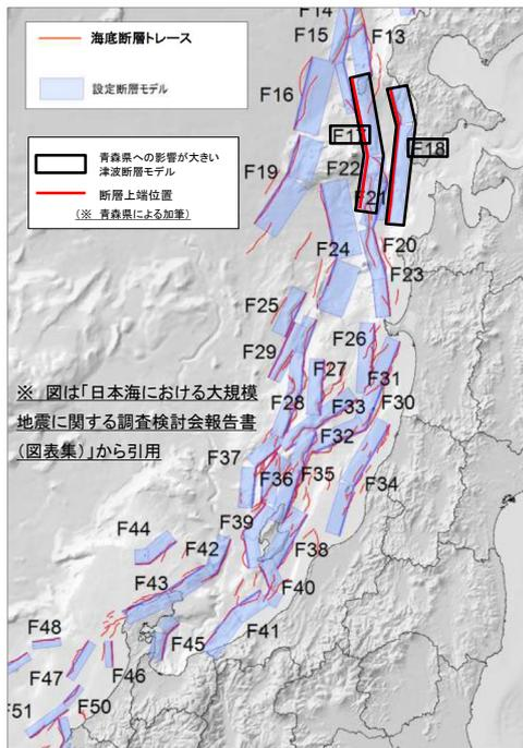
図-7 津波断層モデルの位置 [F17,F18,]
