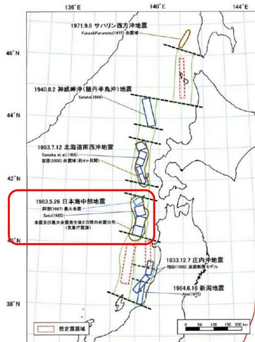
図-4 地震津波の波源域を設定
