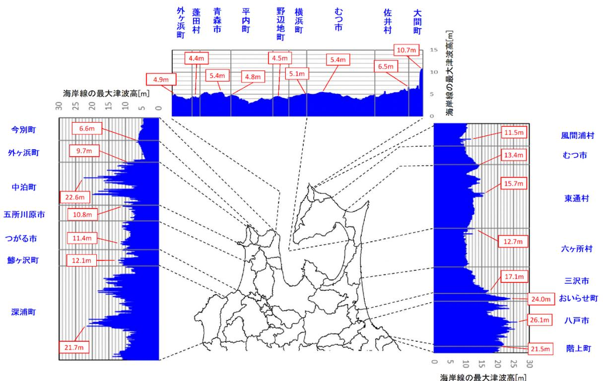
図-31 青森県沿岸における海岸線の最大津波高縦断図
