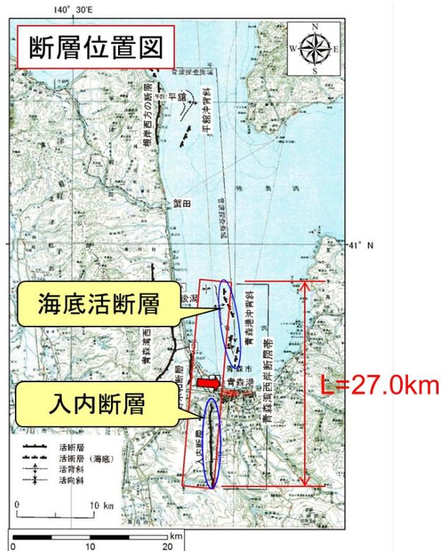
図-5 地震津波の波源域を設定
