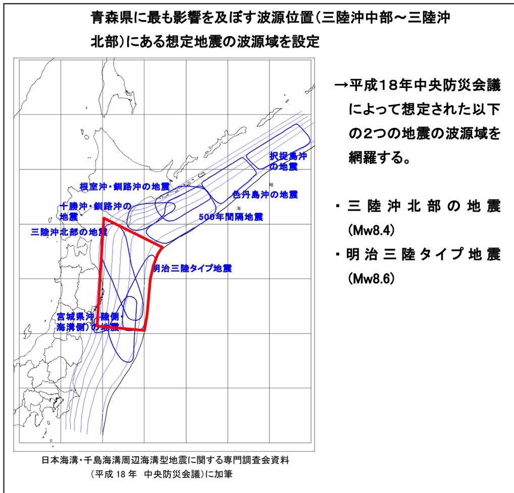
図-1 地震津波の波源域を設定
