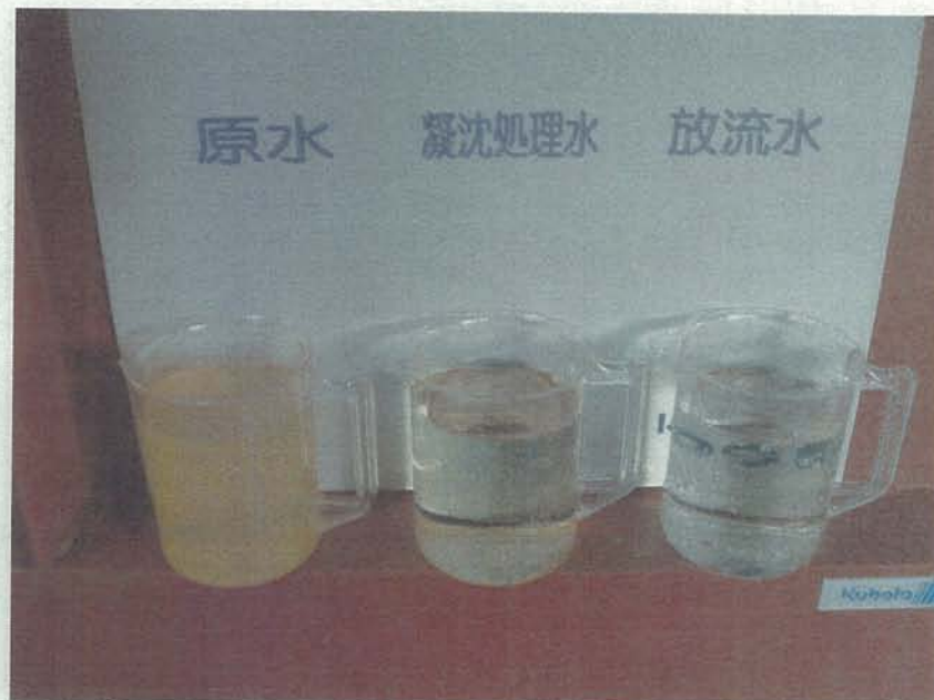
左：原水 中：沈殿処理水 右：放流水
