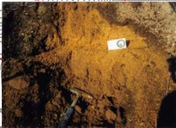
P10. B区北端の尾根筋の露頭 均質なパミス、風化パミスが分布する。層理面の走向・傾斜はN12°E, 15°W.
