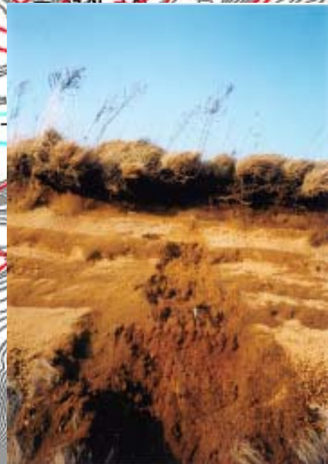
P11. B区の廃棄物 パーク片が主体で自動車部品、塗料缶、ビニール、ガラス片が混入する。
