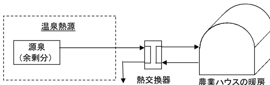
図 2.2-3 奥薬研温泉における温泉熱直接利用融雪システムイメージ図
