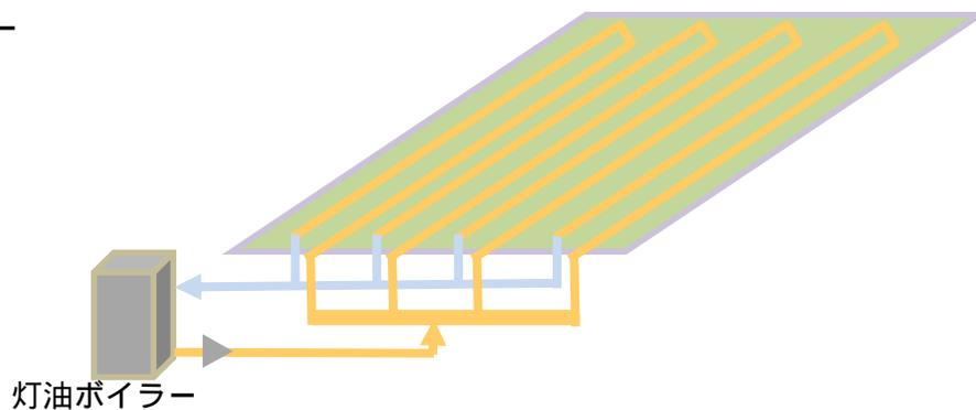
図 3.1-5 灯油ボイラーによる加温システム
