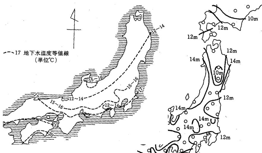
図 1.2-5 50m 以深の地下水温度（左図）と恒温深度分布（右図）
