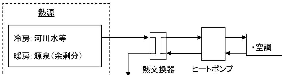
図 2.2-1 薬研温泉における温泉熱利用ヒートポンプシステムイメージ図
