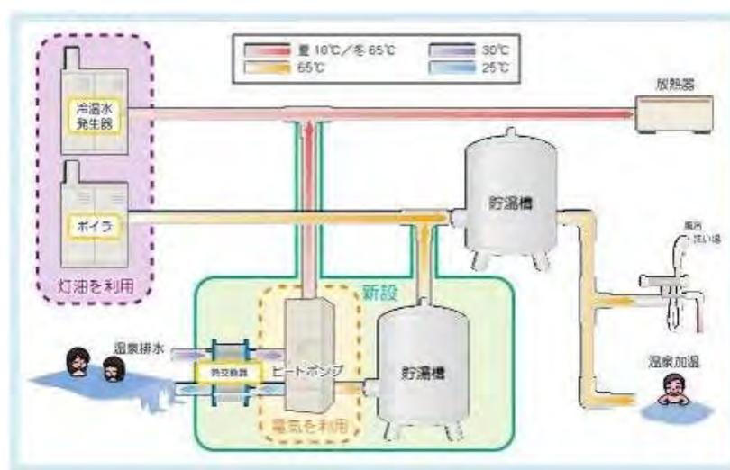
図1.3-3 ヒートポンプによる利用方法イメージ
