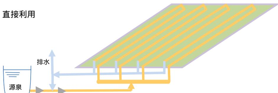
図 3.1-2 温泉の直接利用による加温システム
