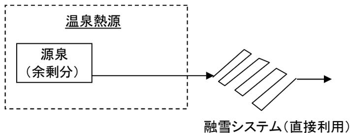
図 2.2-2 奥薬研温泉における温泉熱直接利用融雪システムイメージ図
