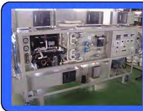
冷凍機をヒートポンプシステムとして運転し、空気調和の実験を行う装置。ヒートポンプは熱移動による冷却技術と、熱回収によって加熱を行う省エネルギー技術です。
