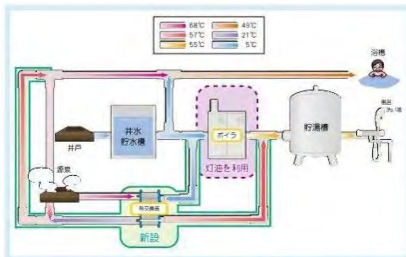
図 1.3-2 熱交換器による利用方法イメージ
