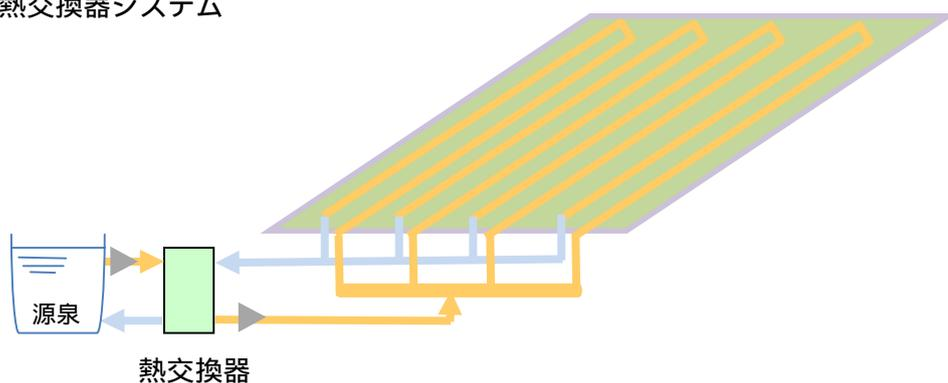
図 3.1-3 温泉の熱交換器による加温システム
