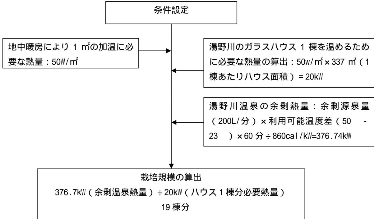
図 3.1-6 栽培規模算出フロー
