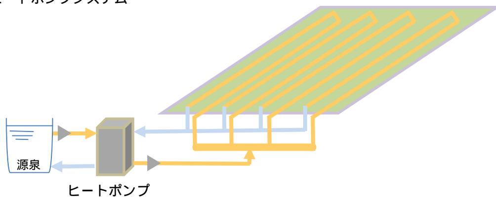
図 3.1-4 温泉のヒートポンプによる加温システム
