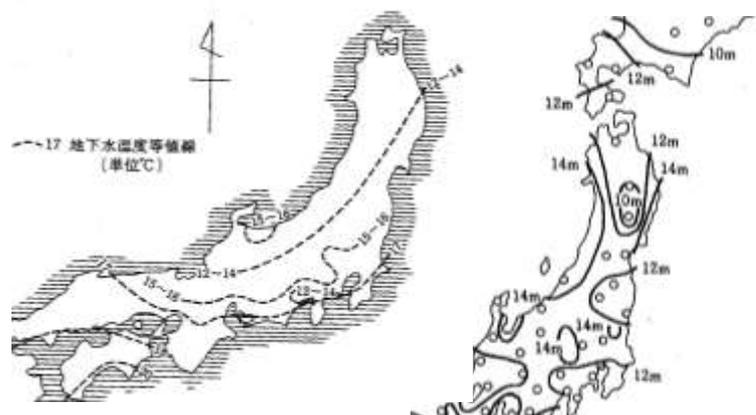
図-2 50m 以深の地下水温度と恒温深度分布
