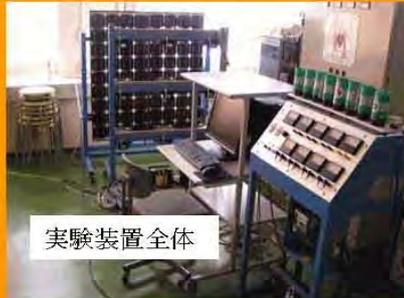
太陽の光エネルギーを受けて、電気エネルギーに変換させる仕組み、日射量やパネルの角度を変化させたときの発電量を測定します。
