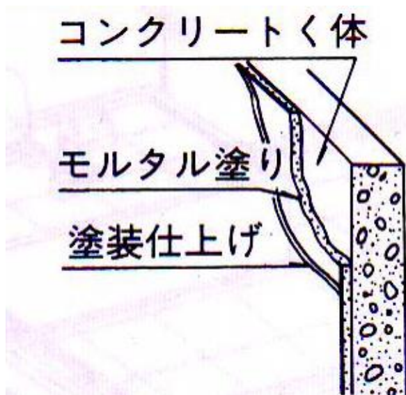
モルタル+塗装
