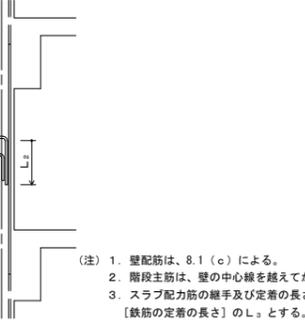
図10.1 片持スラブ形階段配筋の定着
