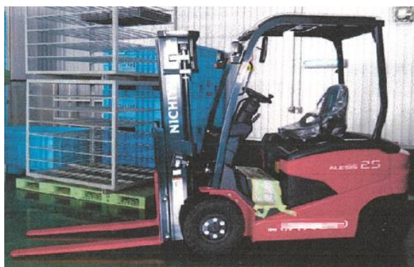
更新後のバッテリーフォークリフト
