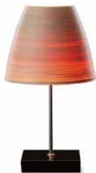
ブナコは、昭和30年代に青森県工業試験場で試作、研究の結果考案された木工品である。日本一の蓄積量を誇る青森県のブナを有効に活用するため、水を多く吸い込むブナの特徴を最大限に生かし、薄いテープ状にして螺旋状に巻き立体の物を形作ることによって、材料となる木材を無駄なく使うことができる。従来の木工品にはないような形状も表現することができ、ひとつひとつが丁寧に手作りされている。現在では食器用品だけではなく、ランプやスピーカーなど、デザイン性の高いインテリア用品にもその技術は応用されている。
