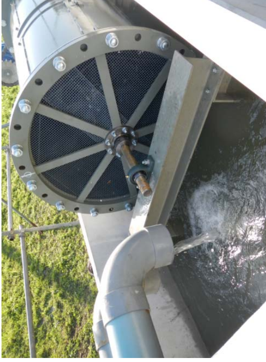
⑥ 動力方式（ロータリーキルン方式）での簡易中和実験
