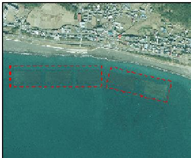
波の勢いを弱め、越波を減少させたり、背後に砂を貯えて、砂浜の侵食を防ぐ施設。(景観に配慮して堤体を水面下にとどめた施設)
