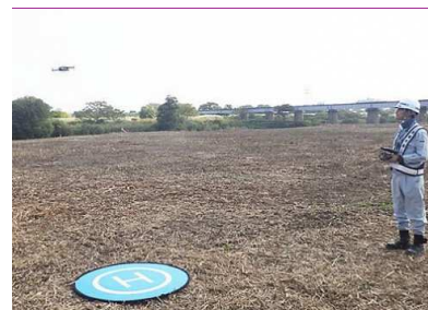
ドローンによる3次元計測
