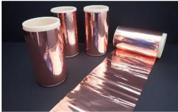
樹脂フィルムの両面にメッキで銅の薄膜をつくる。
