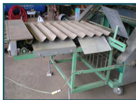
カッターを取り外した選別機
