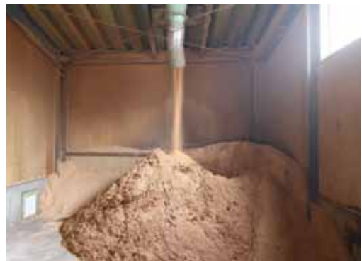
間伐材を機械で破砕してオガ粉にする
