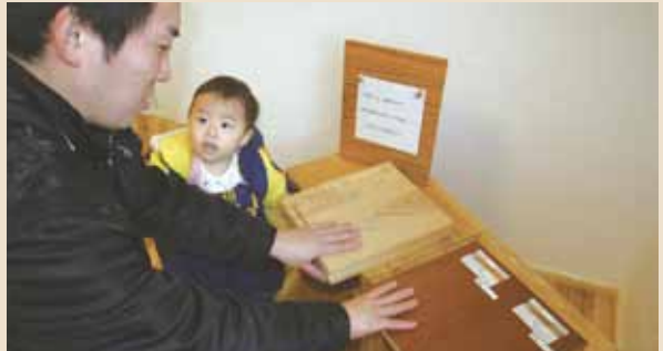
スギ板(左)と合板フロアの表面温度は同じ18.6度でも、触るとスギ板の方が温かく感じられる
