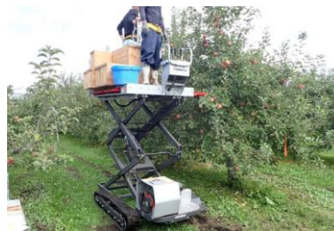
高所作業台車の導入
