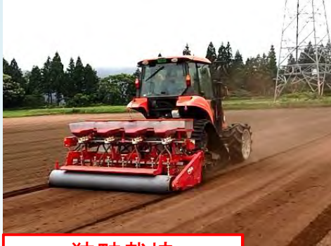
狭畦栽培 スリップローラーシーダ 条間: 30cm 6/26 播種
