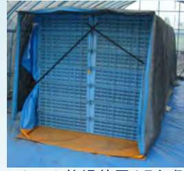
シート乾燥装置(吸引側)
