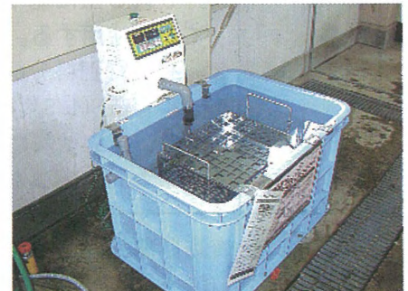
図3 温湯消毒装置付き催芽機『湯芽工房』 (株)タイガーカワシマ社製
