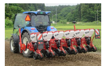
セクションコントロール機能付きバキュームシーダー
