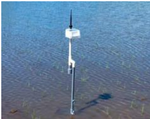
【水田水位センサーによる計測】
