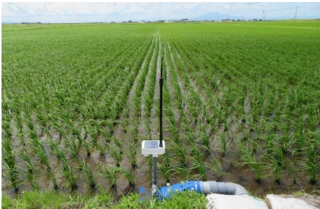
自動給水栓による水管理の省力化 ・ほ場の水位・水温等をスマートフォン等により遠隔で確認、給水口の操作が可能
