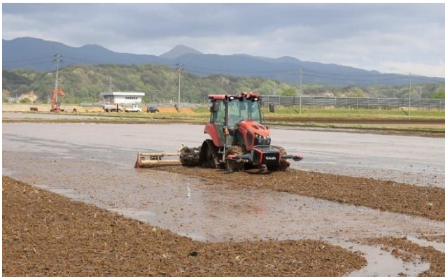
ロボットトラクター（無人）による代かき ・ハンドル操作、発進・停止、作業機制御が自動化され、無人では場内を自動走行
