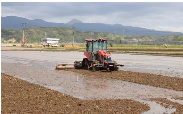
ロボットトラクター（無人）による代かき ・ハンドル操作、発進・停止、作業機制御が自動化され、無人では場内を自動走行
