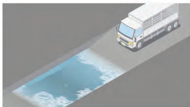
▲車両用消毒槽
